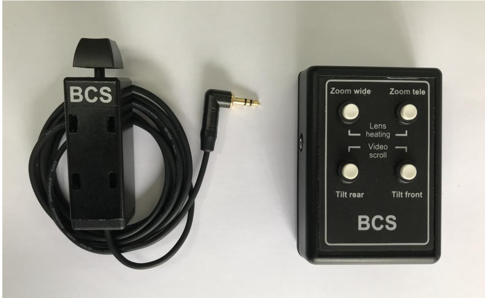
Das Kamerasystem wird mit einer kabellosen Fernbedienung (VH-5540) und einem Joystick (VH-9982) geliefert. Im Falle der Anwendung des Joysticks, Verbindet das Joystick-Kabel mit dem Eingangsbus auf der linken Seite des VH-5540.
